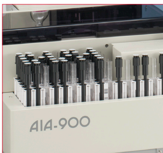
Carga de copas de prueba y muestras en modelos de cargador
