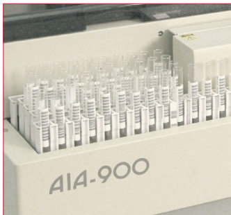
Carga de muestras para modelos con Clasificador
